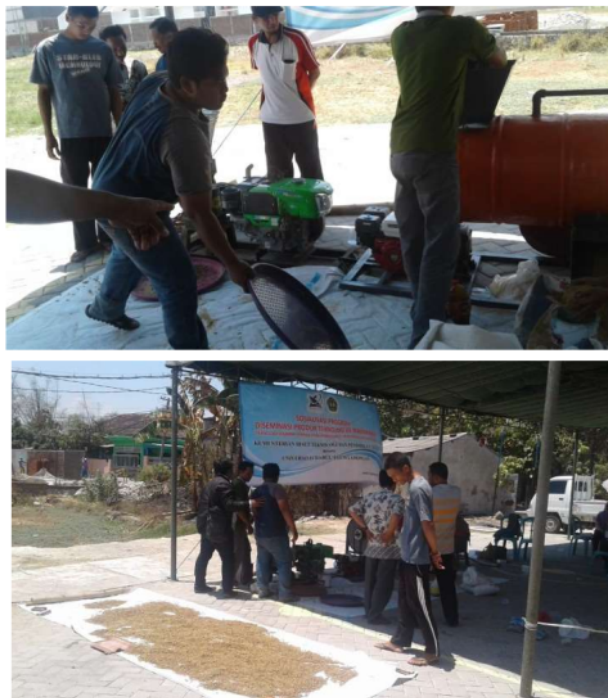
Gambar 3 Proses pembuatan produk pelet ikan apung dengan steamer.
