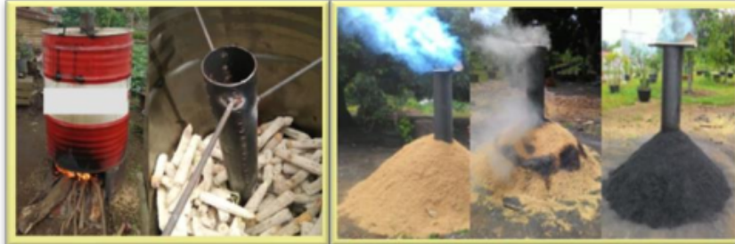
Gambar 16. Gambar tong pirolizer ; tong pirolizer sederhana (kiri) dan pirolizer konvensional (kanan)
