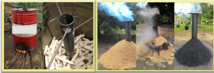
Gambar 16. Gambar tong pirolizer ; tong pirolizer sederhana (kiri) dan pirolizer konvensional (kanan)
